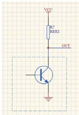
虚线框为蠕动泵内部“OC门”电路；虚线框外需要客户自己连接。
