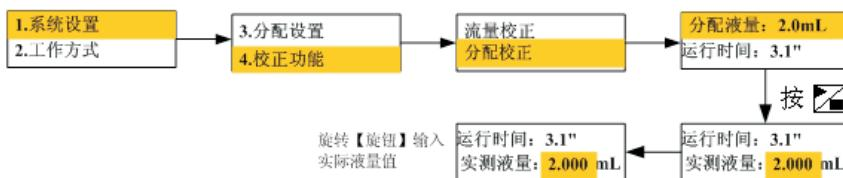
如果已经知道实际误差值，可以直接输入实际液量值，按旋钮进行确认，设置后按【旋钮】保存或按【返回键】取消设置，返回至上级界面。
