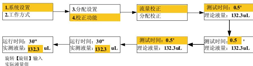
如果在校正前已经知道了实际误差液量，也可以进入校正界面后直接输入液量值，不必重复以上过程。
